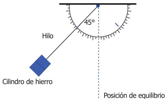
Cuando el péndulo se separa de su posición de equilibrio y se suelta, el peso del cilindro tiende a llevar al péndulo a su posición de equilibrio, ganando velocidad y pasando de largo, creándose así un movimiento de ida y vuelta.
